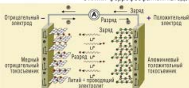
Рис. 2. Устройство литий-ионного аккумулятора с литий-феррофосфатным катодом
